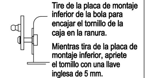
Tire de la placa de montaje inferior de la bola para encajar el tornillo de la caja en la ranura.
