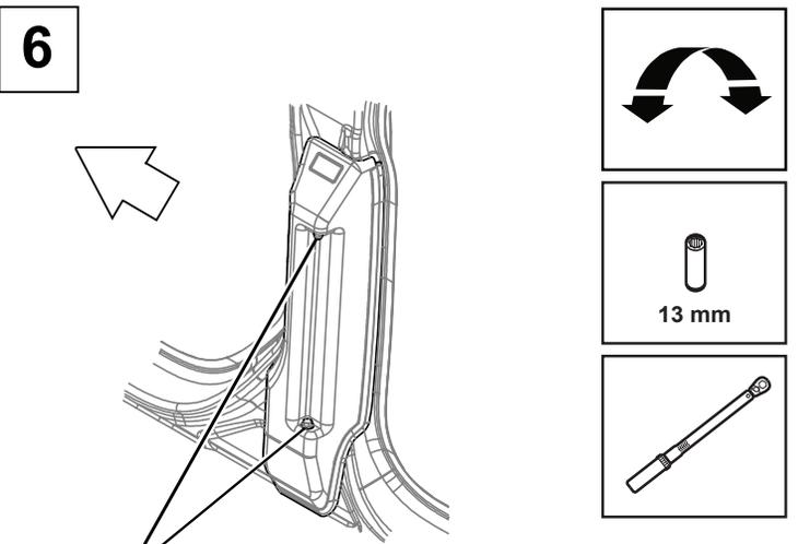
Apriete a mano, luego apriete a una vuelta completa usando un trinquete de 1/4". Asegúrese de que el accesorio esté correctamente asegurado.
