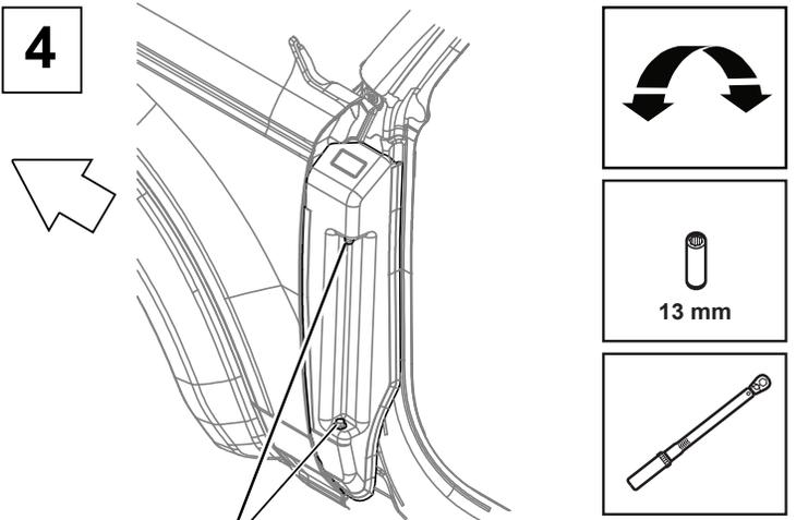
Apriete a mano, luego apriete a una vuelta completa usando un trinquete de 1/4". Asegúrese de que el accesorio esté correctamente asegurado.
