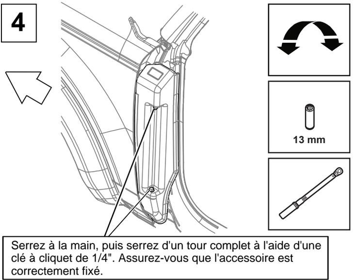
Serrez à la main, puis serrez d'un tour complet à l'aide d'une clé à cliquet de 1/4". Assurez-vous que l'accessoire est correctement fixé.
