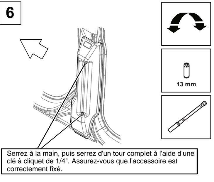
Serrez à la main, puis serrez d'un tour complet à l'aide d'une clé à cliquet de 1/4". Assurez-vous que l'accessoire est correctement fixé.
